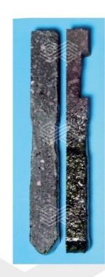
DURITAL RK30NP可以应用于无色玻璃或有色玻璃窑炉的池壁贴砖 修补。而Cr<sub>2</sub>O<sub>3</sub>对于玻璃的污染未见发现。根据一个无色玻璃瓶罐 窑炉在使用铬刚玉贴砖与玻璃液接触后对玻璃化学成分的分析显 示, Cr<sub>2</sub>O<sub>3</sub>含量小于10 ppm, 与正常运行微铬含量一样, 没有变
