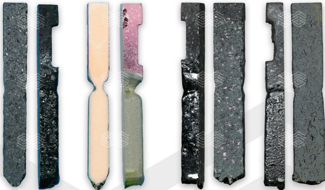
Коррозия SUPRAL RK50S в сравнении с плавнелитыми AZS (бакоровыми) огнеупорами / Corrosion of SUPRAL RK50S compared to fused cast AZS
